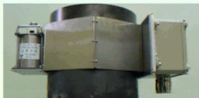
鋼管の厚さ検査
