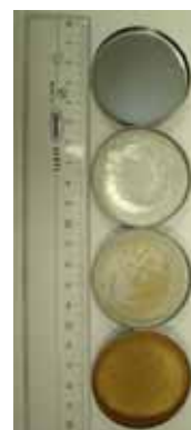
環境水の蒸発乾固およびガスフロー用サンプル (上から、バックグラウンド、水道水、池水、下水)
